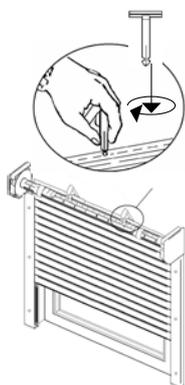
11. Montieren des Revisionsdeckels. Schieben Sie die Feder des Deckels in die Nut des Kastens. Anschließend verschrauben Sie den Deckel am Kasten.
