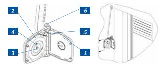
14. Der Rollladen mit ist mit Stoppern (Abb. A) ausgestattet, die mind. 150 mm vom seitlichen und mind. 45 mm vom unteren Rand der unteren Leiste (Abb. B) auf der rechten und linken Seite des Rollladens montiert werden sollen. Drehen Sie ebefalls den Drehstopper in der unteren Leiste in die waagerechte Position (Abb. C).
