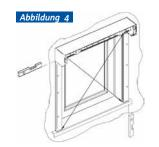
7. In der Wand oder im Fensterrahmen ein Loch durchbohren, durch der Schnur/Gurt in den Raum durchgezogen wird.
