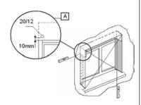
7. In der Wand oder im Fensterrahmen ein Loch durchbohren, durch der Schnur/Gurt in den Raum durchgezogen wird.
