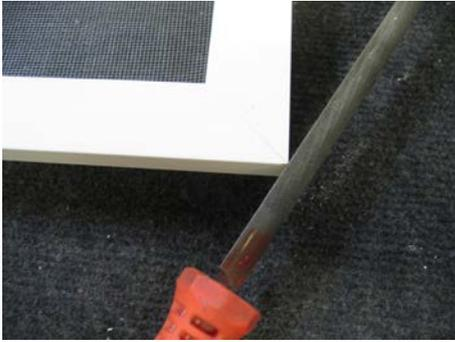
Zum Schluss sollten noch die scharfen Aussenkanten des Spannrahmens mit einer Feile entgradet werden.
