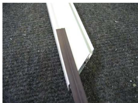
**Achtung! Magnetband und Scharniere müssen unbedingt vor dem Zusammenstecken der Rahmenprofile montiert werden!**
