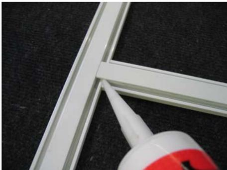
Klebstoff / Silikon in die Nut des Sockelblechs auftragen (verhindert Klappern des Sockelblechs).
