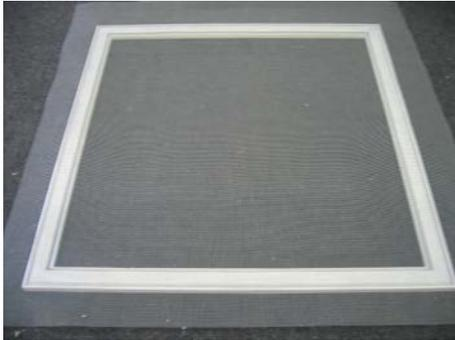
Drehtür mit der Innenseite nach oben (Kederkanal und Bürstenkanal sichtbar) auf den Montagetisch legen. Das Gewebe locker über dem Rahmen platzieren. Dabei auf mind. 10cm Überstand auf jeder Seite achten.
