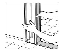
8. Drücken Sie die Kassette auf die montierten Klipse auf. Prüfen Sie, dass die Kassette sauber auf der Bodenführungsschiene aufliegt.
