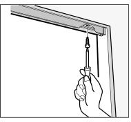
3. Montieren Sie das obere Führungsprofil. Ggf. benötigen Sie, je nach Untergrund andere Schrauben, welche nicht im Lieferumfang beiliegen.
