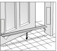
6. Legen Sie die untere Bodenführung in einer Flucht zwischen Verschlussprofil und Klipse. Achten Sie darauf dass diese an der Seite der Klipsseite anliegt. Kleben Sie die Bodenführungsschiene durch abziehen des blauen Schutzbandes auf den Untergrund.
