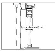
1. Beachten Sie bei der Montage, dass das System ungehindert geöffnet und geschlossen werden kann und keine Türgriffe oder Rollladenschienen blockieren. Achten Sie darauf, dass die gegenüberliegenden Flächen parallel und die Ecken rechtwinklig sind.
