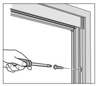
4. Prüfen Sie, dass am Verschlussprofil der Aufkleber "oben" oder "upside" auf der oberseite Setzen Sie das Verschlussprofil unter dem oberen Führungsprofil an und befestigen Sie dieses.
