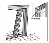
7. Fädeln Sie die Kassette schief in das obere Führungsprofil ein und lösen Sie die Sicherungsbänder. Achten Sie darauf, dass der Aufkleber oben ist.
