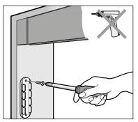
5. Montieren Sie die Befestigungsklipse auf der gegenüberliegenden Seite, parallel zum Verschlussprofil. Diese befinden sich bei Auslieferung bereits in der Kassette und müssen hierzu vorab entnommen werden.
