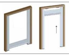
4. Platzieren Sie die Kassette zwischen den Führungsschienen und drücken Sie diese nun auf die gesetzten oberen Klipse auf. Achten Sie darauf hier keine Fäden zu überkreuzen oder ein zu zwicken.
