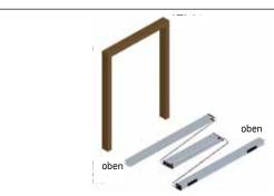
1. Breiten Sie das Paket vor sich aus. Die Führungsschienenseite ohne schwarze Endkappen ist oben. Beachten Sie bei der Montage, dass das System ungehindert geöffnet und geschlossen werden kann und keine Türgriffe oder Rollladenschienen blockieren.
