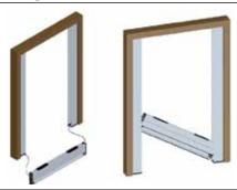
3. Befestigen Sie die Klipse auf Ihrem Anriss. Drücken Sie nun die Führungsschienen auf die gesetzten Klipse auf. Ggf. benötigen Sie, je nach Untergrund andere Schrauben, welche nicht im Lieferumfang beiliegen.
