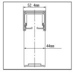
5. Erstellen Sie auf der Kassettenseite einen Anriss von der Mitte des oberen Führungsprofils zum Boden.
