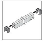
2. Bringen Sie die Ausgleichskappen am oberen Führungsprofil an und achten Sie darauf, dass bei der Montage die Ausgleichskappen auf dem oberen Führungsprofil ganz aufgesteckt sind.
