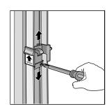
Nur bei Verschlussprofil mit Schnappverschluss: Sie können die Höhe der Verriegelung nachträglich einstellen. Entriegeln Sie hierzu mit einem Kreuz-Schraubenzieher die Stellschrauben und Positionieren Sie die Schnappverschlusshöhe somit neu. Nach erfolgter Einstellung sind die Stellschrauben wieder an zu ziehen.
