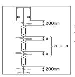
7. Entnehmen Sie der Rückseite der Kasstte die Klipse und befestigen Sie die se wie links im Bild dargestellt. Je nach Türhöhe liegen zwischen 3 - 5 Klipse der Tür bei.
