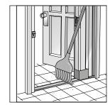
Entfernen Sie Steine oder größere Verschmutzung regelmäßig von der Bodenführungsschiene.
