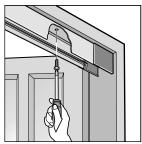
3. Montieren Sie das obere Führungsprofil. Ggf. benötigen Sie, je nach Untergrund andere Schrauben, welche nicht im Lieferumfang beiliegen.
