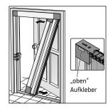
8. Fädeln Sie die Kassette schief in das obere Führungsprofil ein und lösen Sie die Sicherungsbänder. Achten Sie darauf, dass der Aufkleber oben ist. Drücken Sie die Kassette auf die Klipse auf. Bei Doppeltüren wiederholen Sie den Vorgang auf der gegenüberliegenden Seite.
