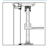
1. Beachten Sie bei der Montage, dass das System ungehindert geöffnet und geschlossen werden kann und keine Türgriffe oder Rollladenschienen blockieren. Achten Sie darauf, dass die gegenüberliegenden Flächen parallel und die Ecken rechtwinklig sind. Systembreite: Schnappverschl. 54mm, Magnet 52mm.
