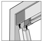
4. Einzeltür: prüfen Sie, dass am Verschlussprofil der Aufkleber "oben" oder "upside" auf der oberseite ist. Setzen Sie
