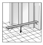
6. Legen Sie die untere Bodenführung in einer Flucht zwischen Verschlussprofil Anriss (Doppeltüren beidseitig Anriss). Achten Sie darauf dass diese an der Klipsseite anliegt. Kleben Sie die Bodenführungsschiene durch abziehen des blauen Schutzbandes auf den Untergrund.
